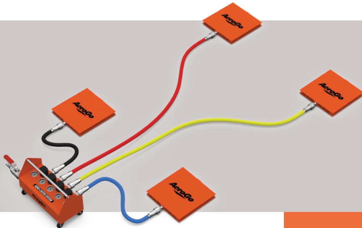
Les systèmes de coussins d'air AeroGo® Gapmaster tirent profit de l'efficacité des coussins d'air, une technologie de film fluide, qui utilisent l'air comprimé pour faire flotter des charges lourdes sur un film d'air presque sans frottement.
